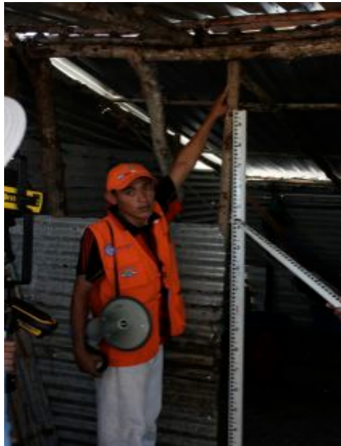
Foto 3 . Altura de Ola alcanzada en Isla de Méndez.
